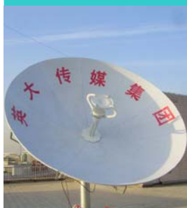
国家电网报社卫星 传版系统主站天线
